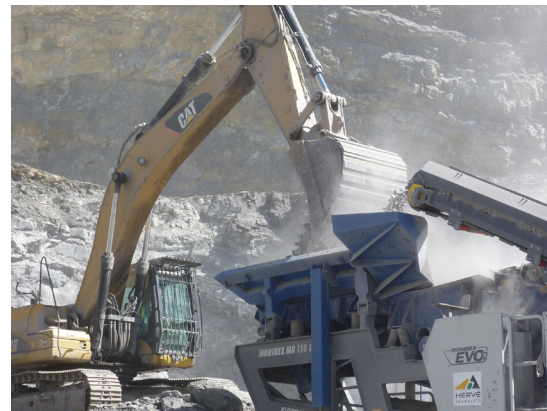
Le chargement de la trémie du groupe mobile par la pelle
