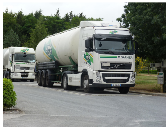
Camion-citerne pour la livraison des produits pulvérulents (sur le pont bascule)
