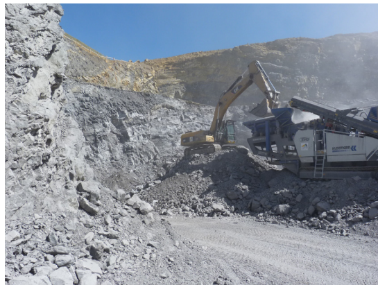
Le chargement de la trémie du groupe mobile par la pelle
